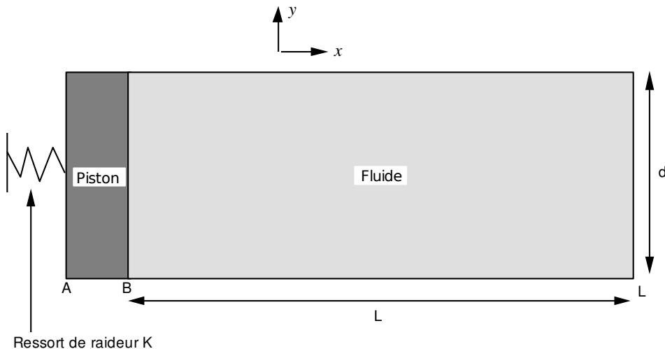
Piston en acier relié au massif par un ressort et couplé à une colonne de fluide incompressible :
