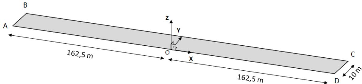
L'épaisseur de la membrane est renseignée dans `AFPE_CARA_ELEM` via le mot clé `EPAIS` et vaut  $e = 2,2783 \cdot 10^{-5}\text{ m}$ . Cette épaisseur est choisie de façon à obtenir une masse égale à celle utilisée dans le cas test `SSNL114`, à masse volumique identique.
