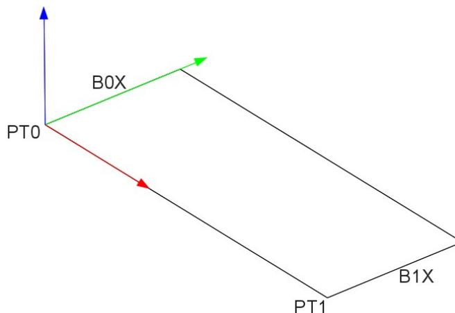
Dalle :  $5\text{m} \times 3\text{m}$ , d'épaisseur  $0.25\text{ m}$ , sur appuis simples en  $B0X$  et  $B1X$ .
