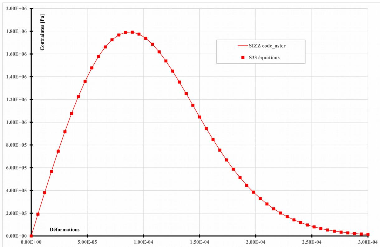
Figure 2.2-a : Traction sur cube libre, comparaison entre code\_aster et la solution théorique.
