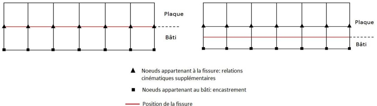
Pour un maillage **quadratique** voici la stratégie à suivre : maillage conforme (gauche) et non conforme (droite, avec fissure au milieu des éléments)
