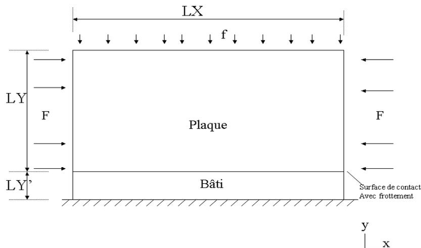
La structure est un rectangle constitué de deux plaques de même matériau, séparées par une interface.
