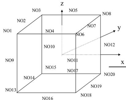
L'essai triaxial est effectué sur un seul élément fini isoparamétrique de forme cubique HEXA20. La longueur de chaque arête vaut 1. On définit les mailles suivantes :
