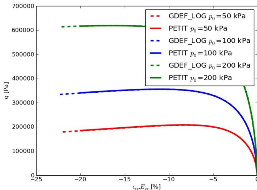
Figure 5 : Contrainte équivalente (notée «  $Q$  ») en fonction de la déformation axiale : comparaison entre les solutions à petites et grandes déformations dans Code\_Aster, pour les pressions de consolidation de 50 , 100 et 200kPa .
