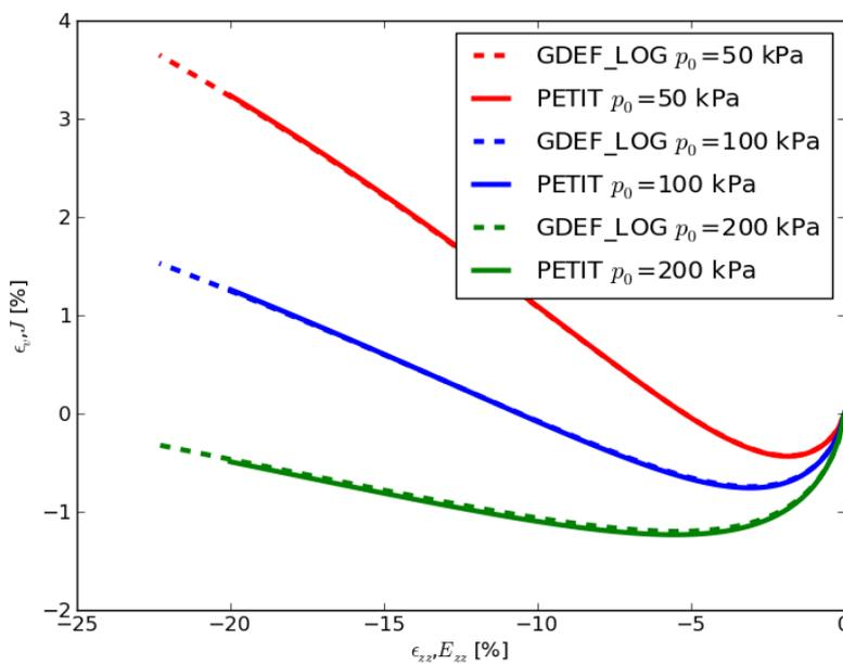
Figure 6 : Déformation volumique totale en fonction de la déformation axiale : comparaison entre les solutions à petites et grandes déformations dans Code\_Aster, pour les pressions de consolidation de 50 , 100 et 200kPa .
