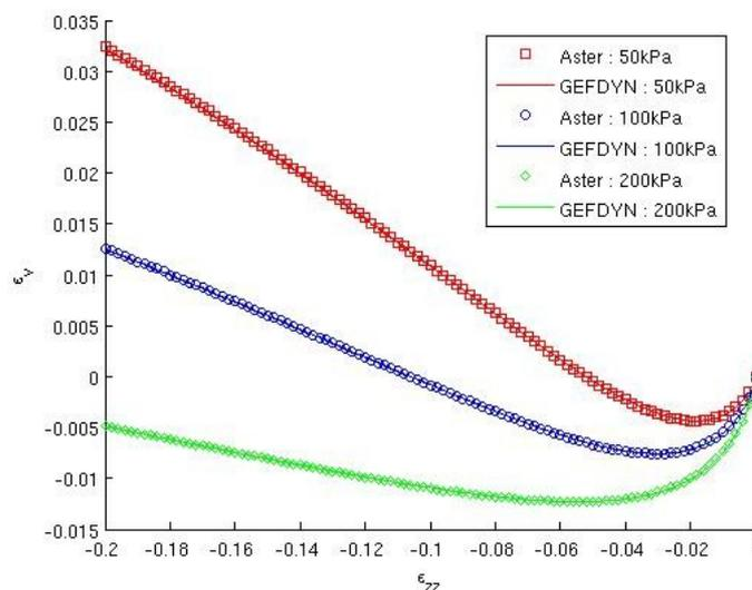
Figure 2 : Déformation volumique totale (notée «  $EPSv$  ») en fonction de la déformation axiale : comparaison entre les solutions Code\_Aster et Xloi, pour les pressions de consolidation de 50, 100 et 200kPa .
