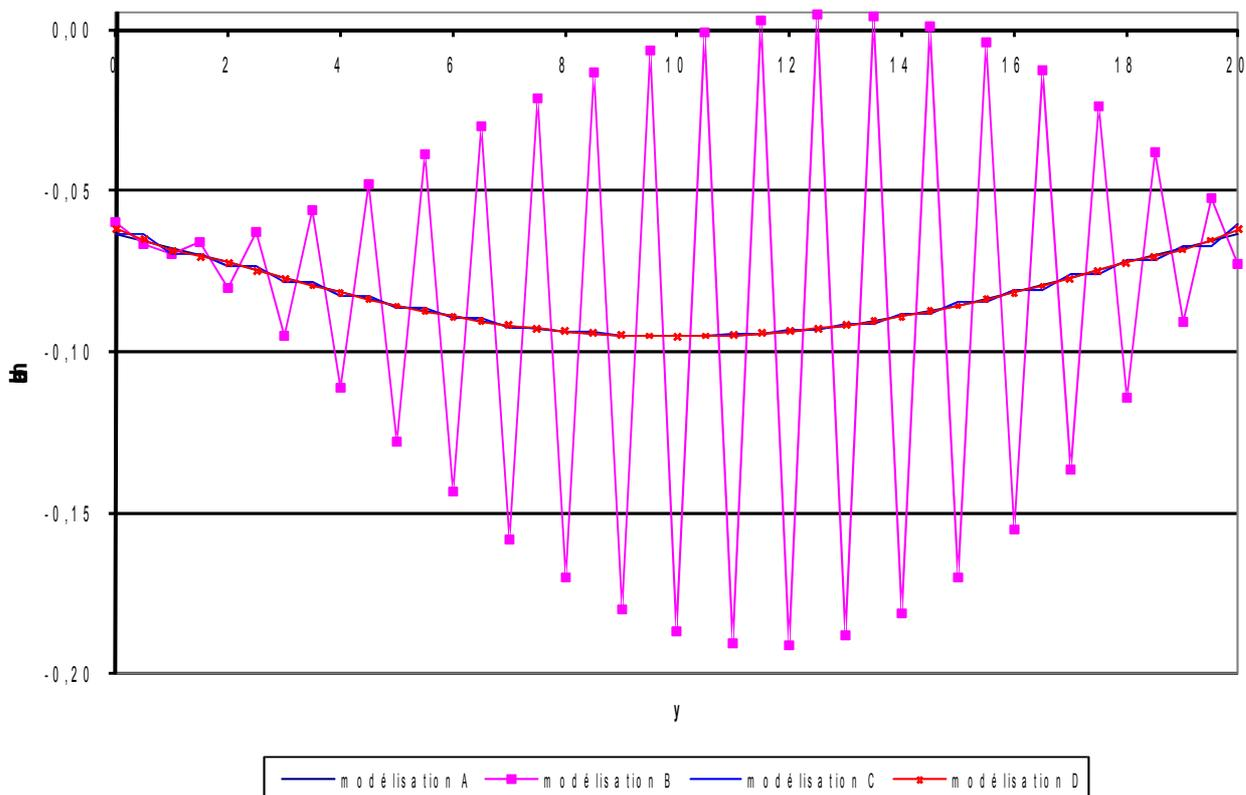
**Figure 7.2-1 : Comparaison des pressions de contact suivant les modélisations (pressions exprimées en GPa)**
