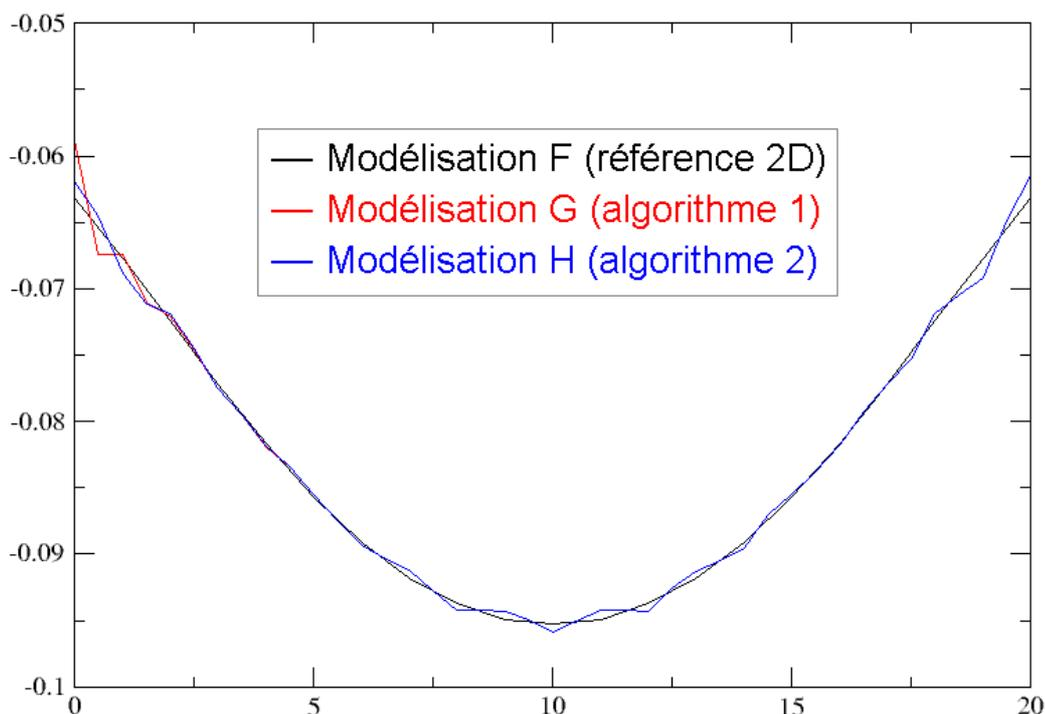
Figure 11.2-1 : Comparaison des pressions de contact suivant les modélisations 2D (pression exprimées en GPa).
