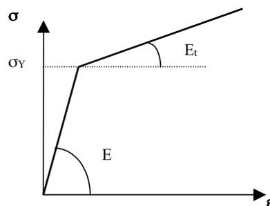
Le module d'Young  $E$ , le module tangent  $E_t$  ainsi que le coefficient de Poisson ne dépendent pas de la température. On prend :  $E = 200 \text{ GPa}$ ,  $E_t = 2000 \text{ MPa}$  et  $\nu = 0,3$ .
