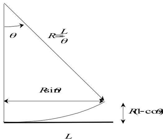
Suivant la solution d'Euler, la déformée est un arc de cercle. A la section  $P_2 P_3$  ( $x=L$ ), la rotation vaut :
