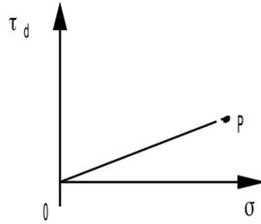
$\sigma_d(t)$  et  $\tau_d(t)$  linéaires, le point  $P$  étant atteint en  $10\text{ s}$  avec  $\sigma_d(10)=150\text{ MPa}$  et  $\tau_d(10)=60\text{ MPa}$ .
