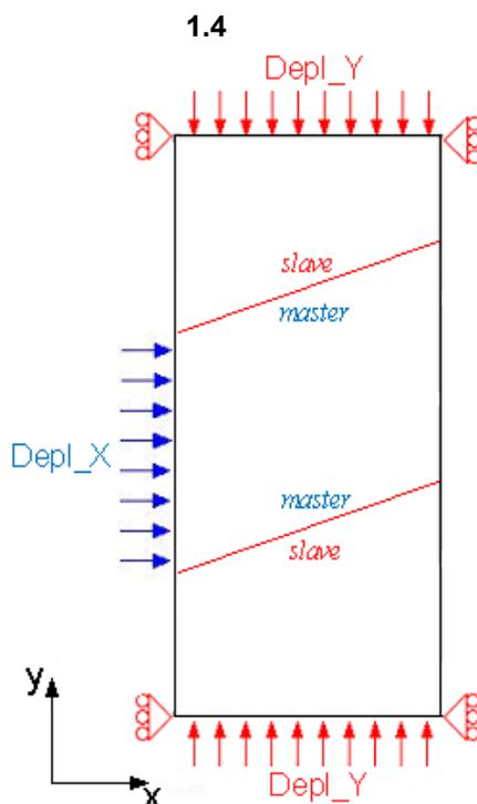
Figure 1.3-1 : Illustration des conditions aux limites et des chargements.
