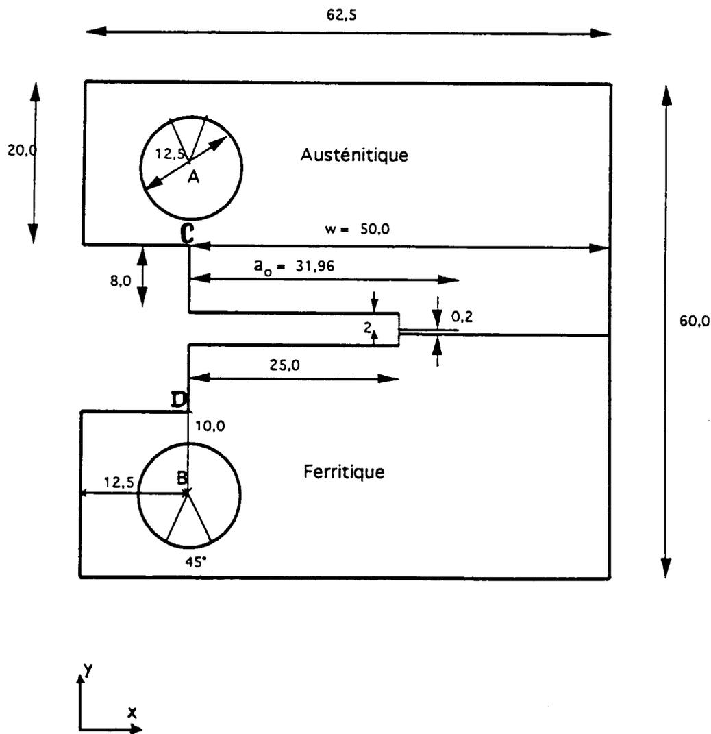
Toutes les cotes sont exprimées en *mm* . La fissure se trouve à 0,2 *mm* de l'interface, dans la partie supérieure de l'éprouvette.
