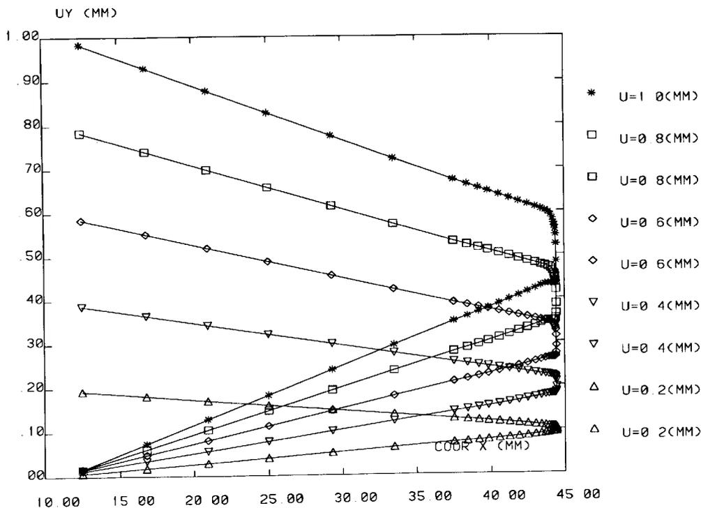
Fig.10 Déplacements des deux lèvres de la fissure au cours du chargement
