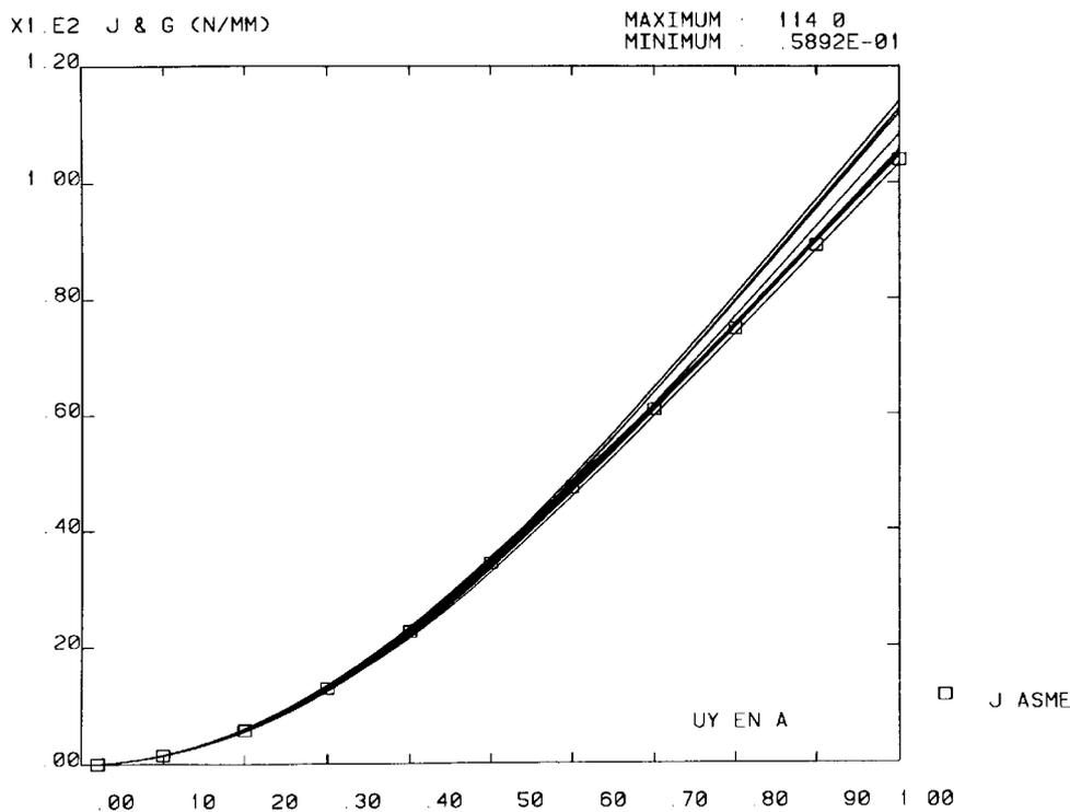
Fig.11 G et  $J_{ASTM}$  en fonction du déplacement imposé et suivant les 13 courbes du vecteur  $\theta$
