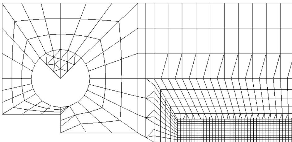
Figure 4 : Maillage de l'éprouvette CT en 2D.
