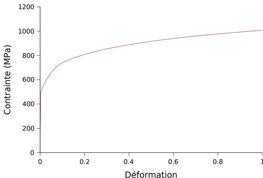
Figure 2 : Courbe d'écrouissage isotrope du matériau volumique.
