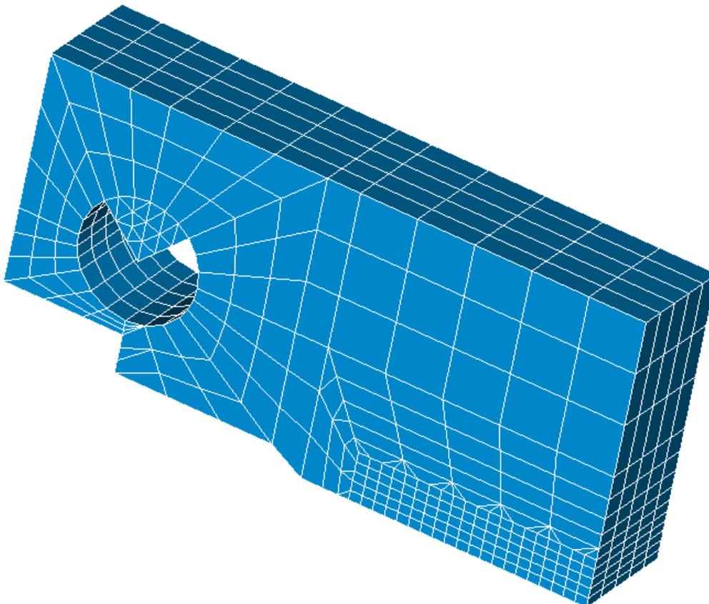
Figure 5 : Maillage de l'éprouvette CT en 3D.
