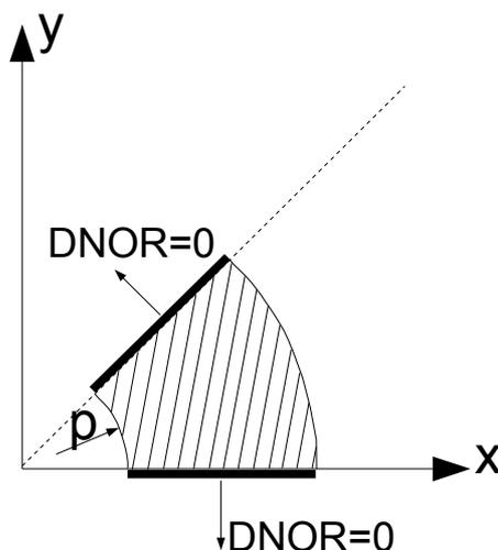
Figure 3.1-a : géométrie de la structure – modèle axisymétrique
