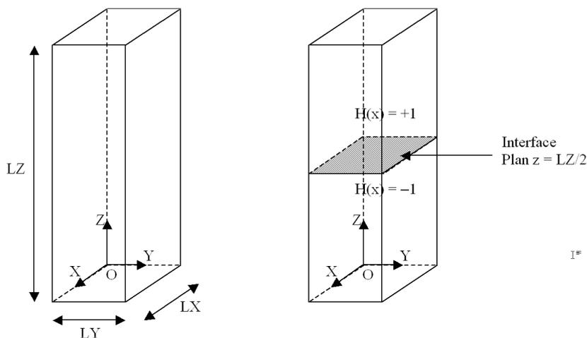
Figure 1.1-a : Géométrie du barreau et positionnement de l'interface
