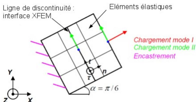
Figure 2 : Modélisation X-FEM dans le plan  $(X, Y)$ . On choisit  $L = 1 \text{ mm}$ .
