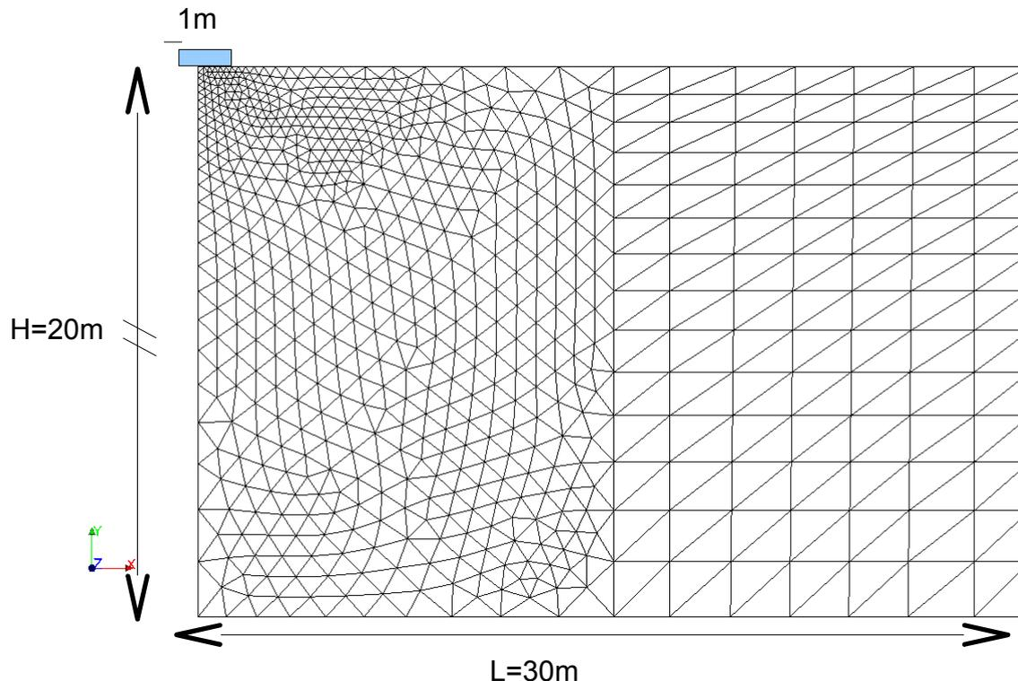
Le maillage ci-dessus représente une semelle rigide reposant sur un demi-espace de sol. La fondation a une largeur de  $2\text{ m}$ . Elle est soumise à un enfoncement verticale linéaire en fonction du temps. En exploitant la symétrie verticale du problème, seule une moitié du sol est représenté. Le modèle de sol représenté a une géométrie rectangulaire de hauteur  $H = 20\text{ m}$  et de largeur  $L = 30\text{ m}$ . Le maillage, raffiné autour de la fondation, comporte 1297 éléments TRIA3.
