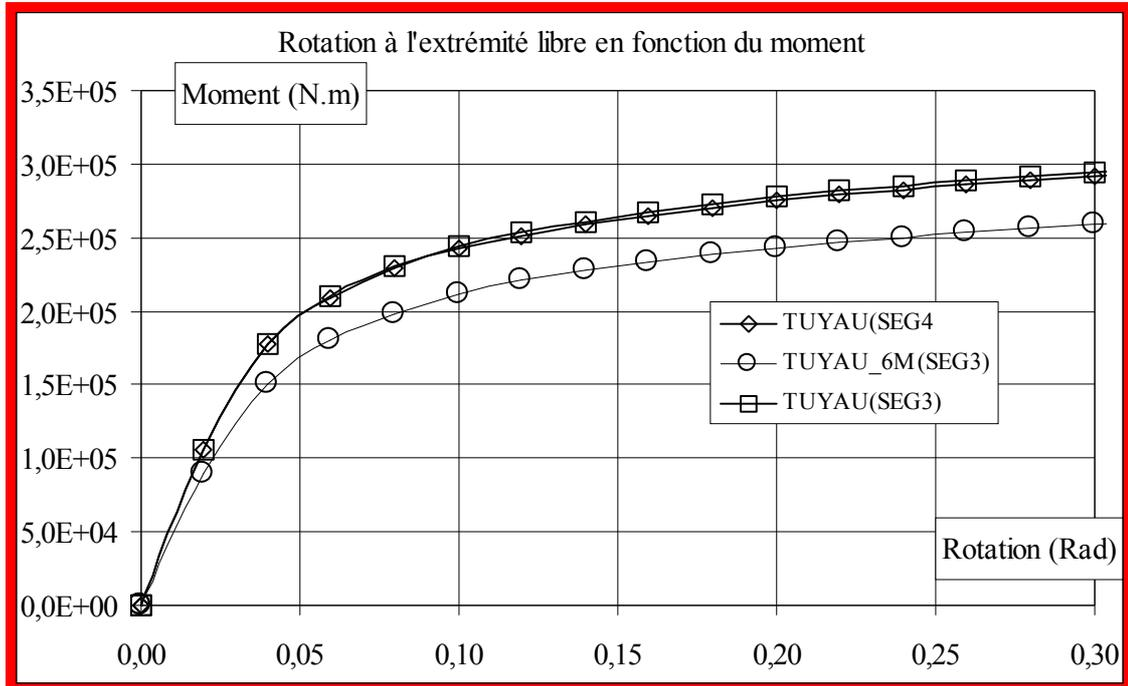
Les résultats obtenus pour la modélisation TUYAU (SEG3 et SEG4) sont assez éloignés de la solution de référence, (erreur de 20%). Par contre, ils sont meilleurs pour la modélisation TUYAU\_6M (erreur de 6%).
