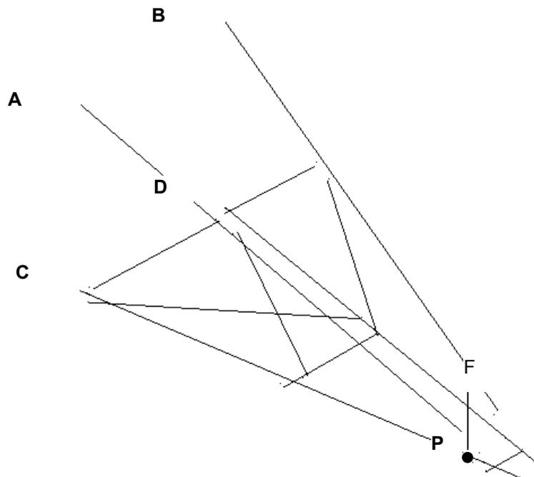
La modélisation des assemblages boulonnés est assurée par des discrets dont les raideurs sont fixées de manière forfaitaire. Les excentrement des points d'attache sont pris en compte (ce qui explique que les éléments ne sont pas concourants). Le modèle est obtenu à partir du pré-processeur EVEREST.
