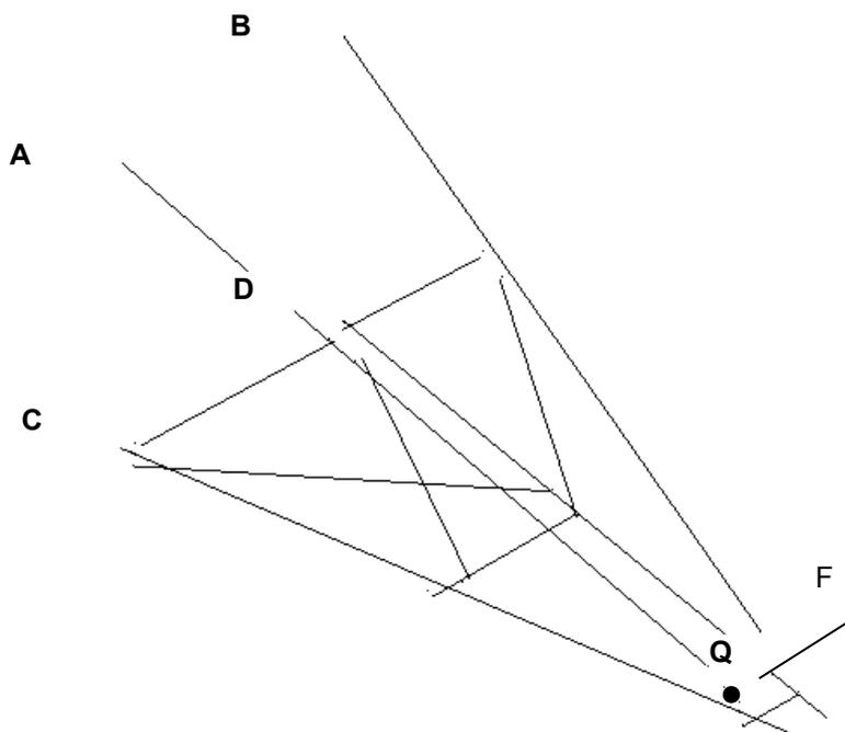
La modélisation des assemblages boulonnés est assurée par des discrets dont les raideurs sont fixées de manière forfaitaire. Les excentrement des points d'attache sont pris en compte (ce qui explique que les éléments ne sont pas concourants). Le modèle est obtenu à partir du pré-processeur EVEREST.
