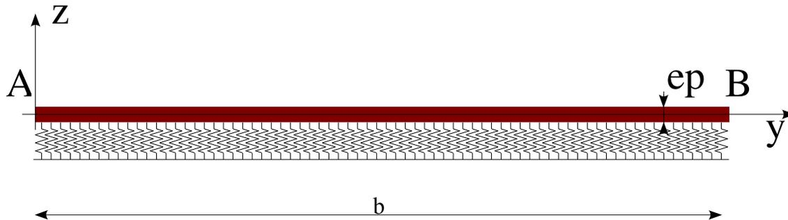
Figure 1.1-a : Schéma de la plaque et des ressorts dans le plan  $(y, z)$ .
