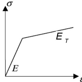
Figure 1.2-a : courbe de contrainte – déformation de l'acier
