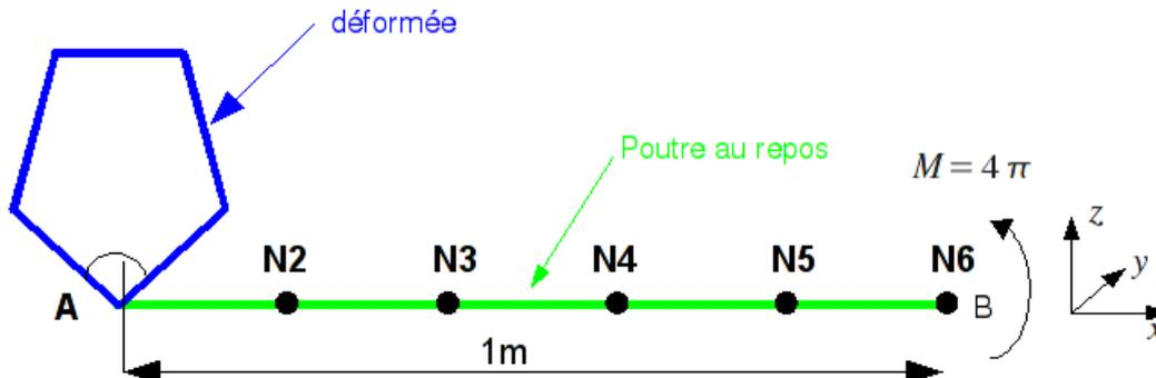
Poutre droite  $AB$ , de longueur  $l=1\text{m}$ , encastée en  $A$  et soumise en  $B$  à un moment  $M$ .
