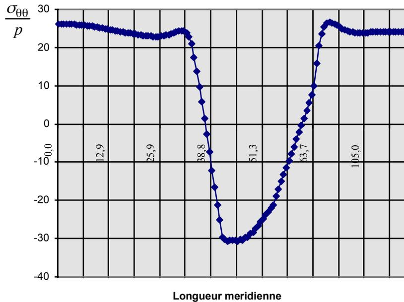
Variation de la contrainte azimutale  $\sigma_{\theta\theta}$  sur la peau inférieure le long de la section meridienne au voisinage de la ruine pour une pression interne  $p_{max}$ . Calcul linéaire géométrique.
