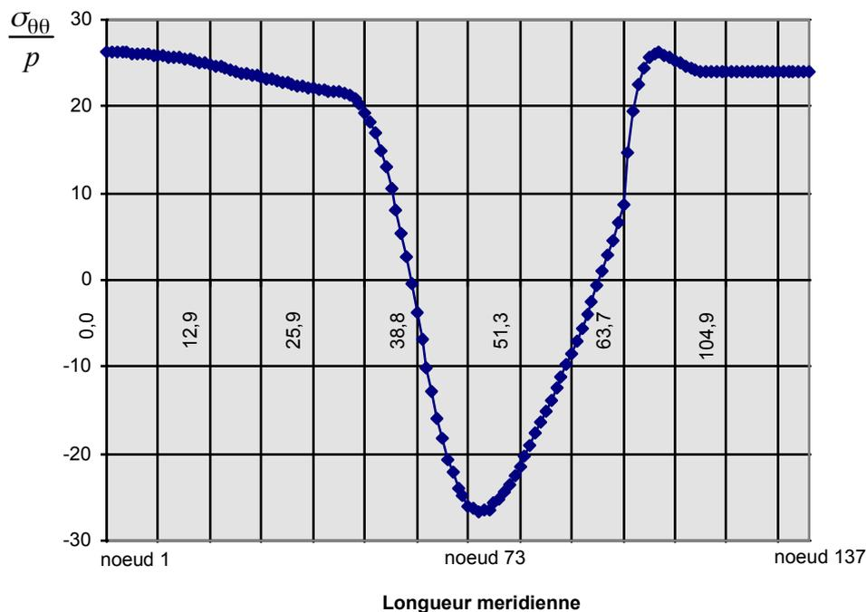
Variation de la contrainte azimutale  $\sigma_{\theta\theta}$  sur la peau inférieure le long de la section meridienne au voisinage de la ruine pour une pression interne  $p_{max}$ . Calcul non linéaire géométrique.
