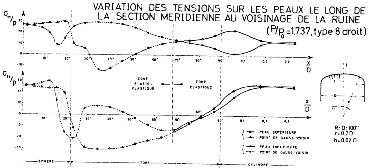
Variation de la contrainte azimutale  $\sigma_{\theta\theta}$  sur la peau supérieure le long de la section meridienne au voisinage de la ruine pour une pression interne  $p_{max}$ . Calcul linéaire géométrique.
