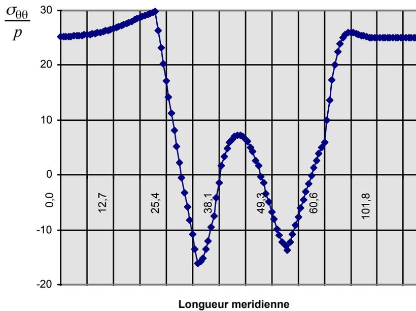
Variation de la contrainte azimutale  $\sigma_{\theta\theta}$  sur la peau supérieure le long de la section meridienne au voisinage de la ruine pour une pression interne  $p_{max}$ . Calcul non linéaire géométrique.
