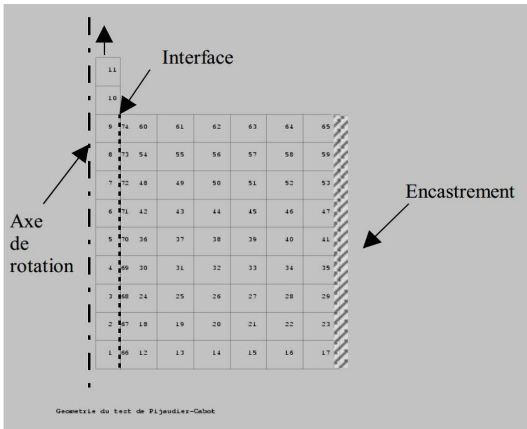
Figure 4.1-a : Modélisation du test en axisymétrique
