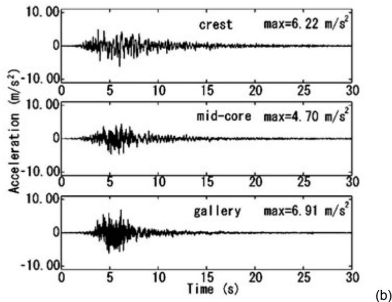
Figure 1.1.2-a : (a) Accélérations horizontales à la base (gallery), au milieu du noyau et en crête ;
