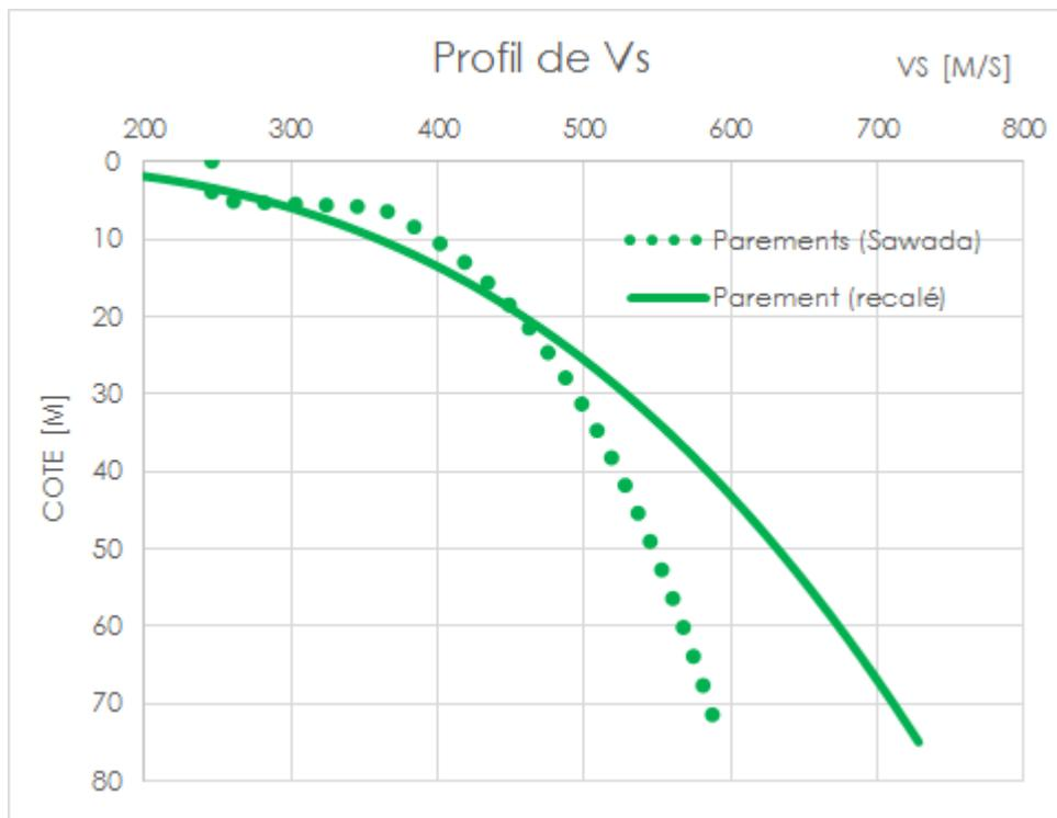
**Figure 1.4.1-a : Profil de Vs dans les parements.**
