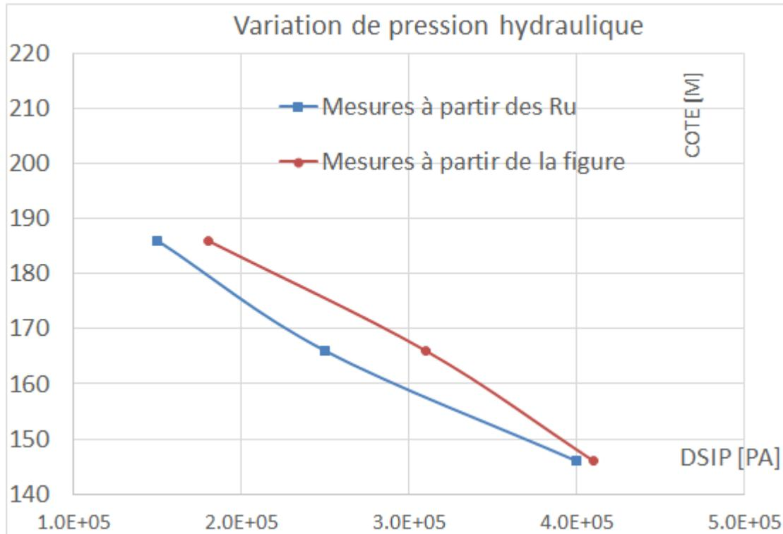
Figure 1.7.2-b : Augmentation de pression interstitielle après le séisme (au 14 juin 2008) calculée à partir de Ru et des isovaleurs de pression interstitielle de la Figure 1.7.2-a
