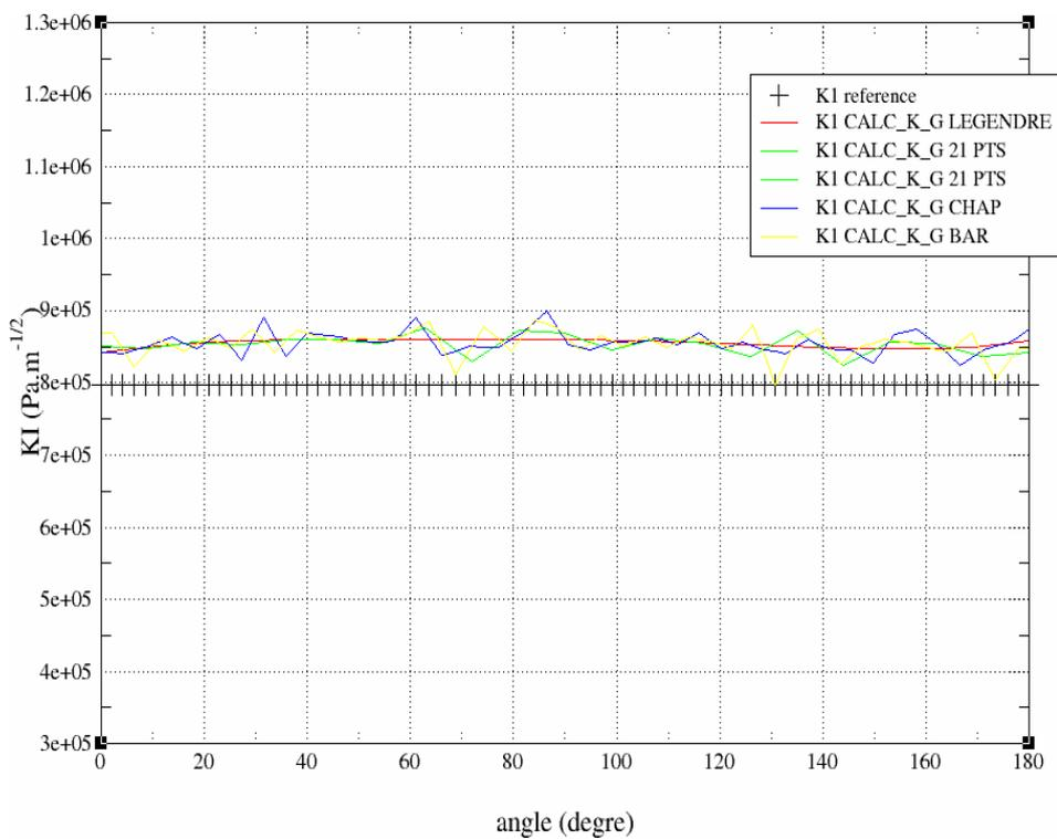
Figure 6.4-2: K1 le long du fond de fissure
