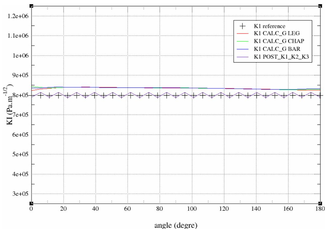
Figure 3.4-2: K1 le long du fond de fissure
