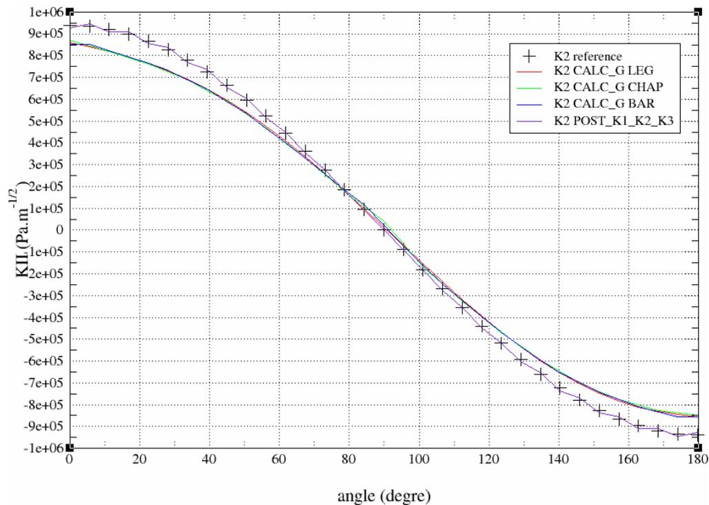
Figure 3.4-3: K2 le long du fond de fissure
