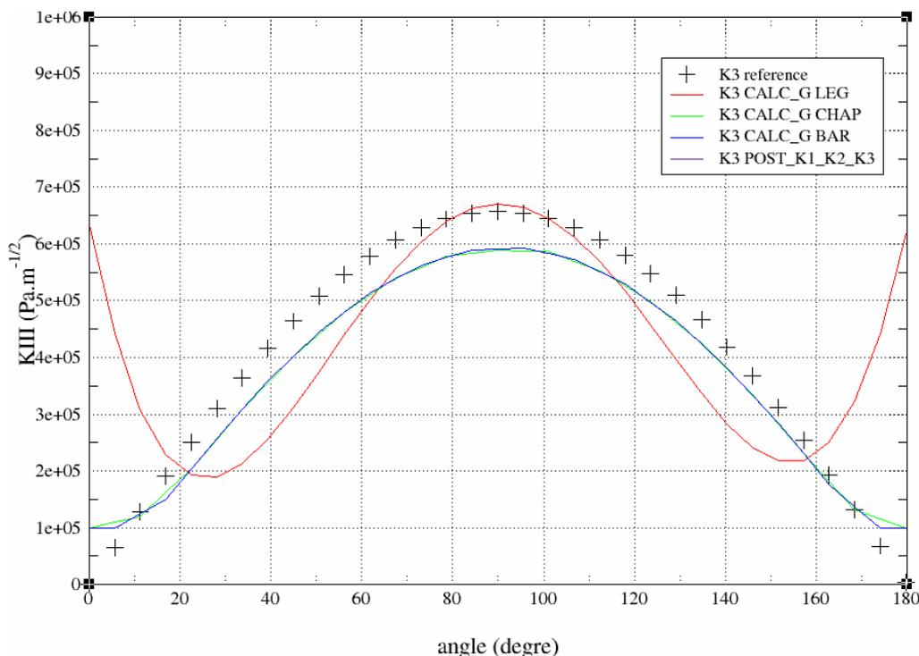
Figure 3.4-4: K3 le long du fond de fissure
