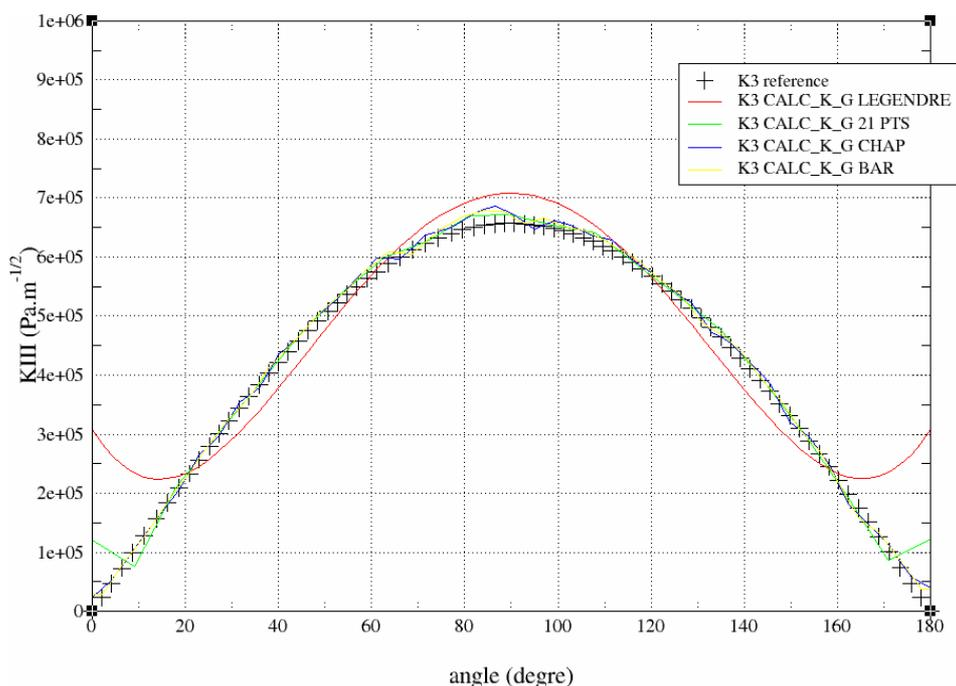
Figure 6.4-4: K3 le long du fond de fissure
