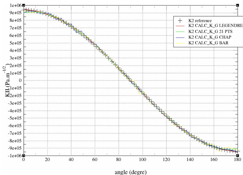
Figure 6.4-3: K2 le long du fond de fissure
