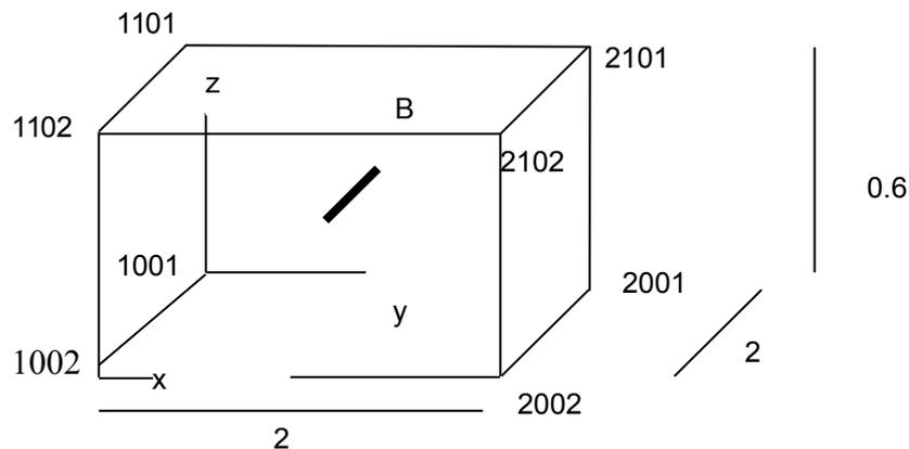
Toutes les dimensions sont en mètres. L'aire des sections transversales du câble vaut  $A=0.00015\text{ m}^2$ . Le câble est parallèle à l'axe  $x$ . Son intersection avec le plan  $(Oyz)$  est définie par le point  $(1., 0.3)$ .
