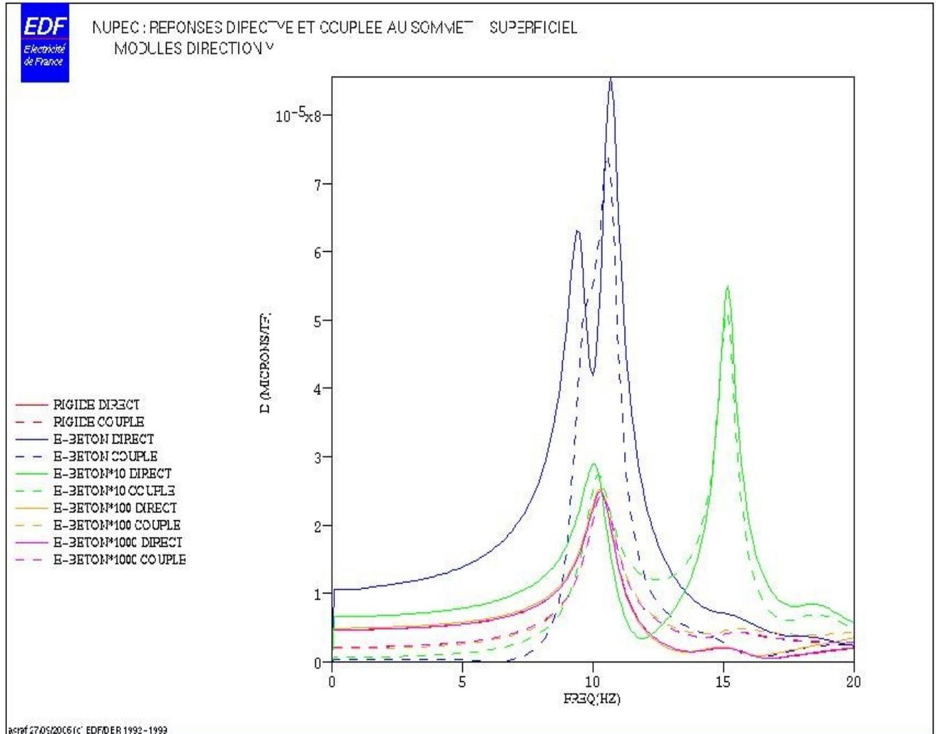
Figure 5-b : Comparaison des modules des réponses directe et couplée à l'excitation harmonique entre cas rigide et cas souple avec augmentation du module de la fondation de liaison dans la direction  $Y$ .
