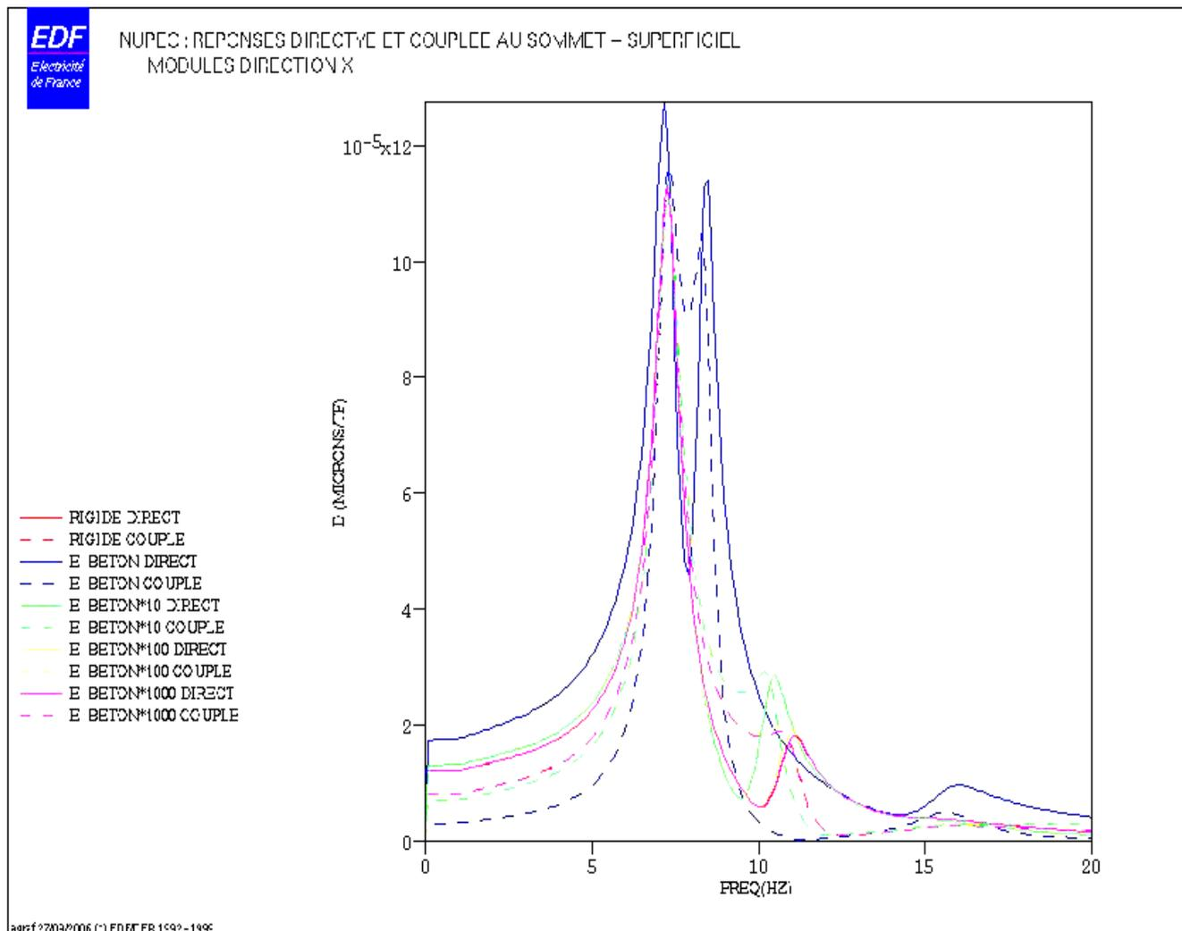
Figure 4-a : Comparaison des modules des réponses directe et couplée à l'excitation harmonique entre cas rigide et cas souple avec augmentation du module de la fondation de liaison dans la direction  $X$ .
