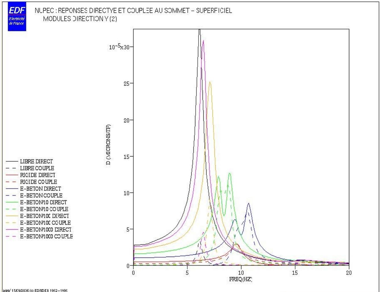
**Figure 5-d : Comparaison des modules des réponses directe et couplée à l'excitation harmonique entre cas rigide découplé et cas souple avec diminution du module de la fondation de liaison dans la direction Y.**
