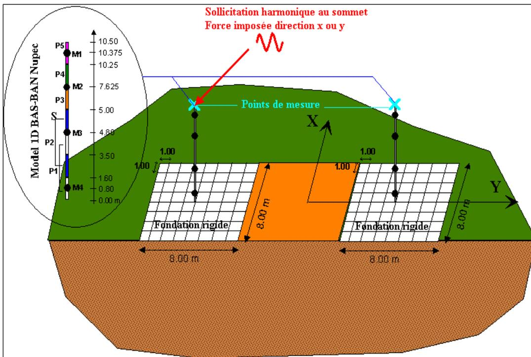
Figure 1.1-b : Modèles et maillages surfaciques des fondations
