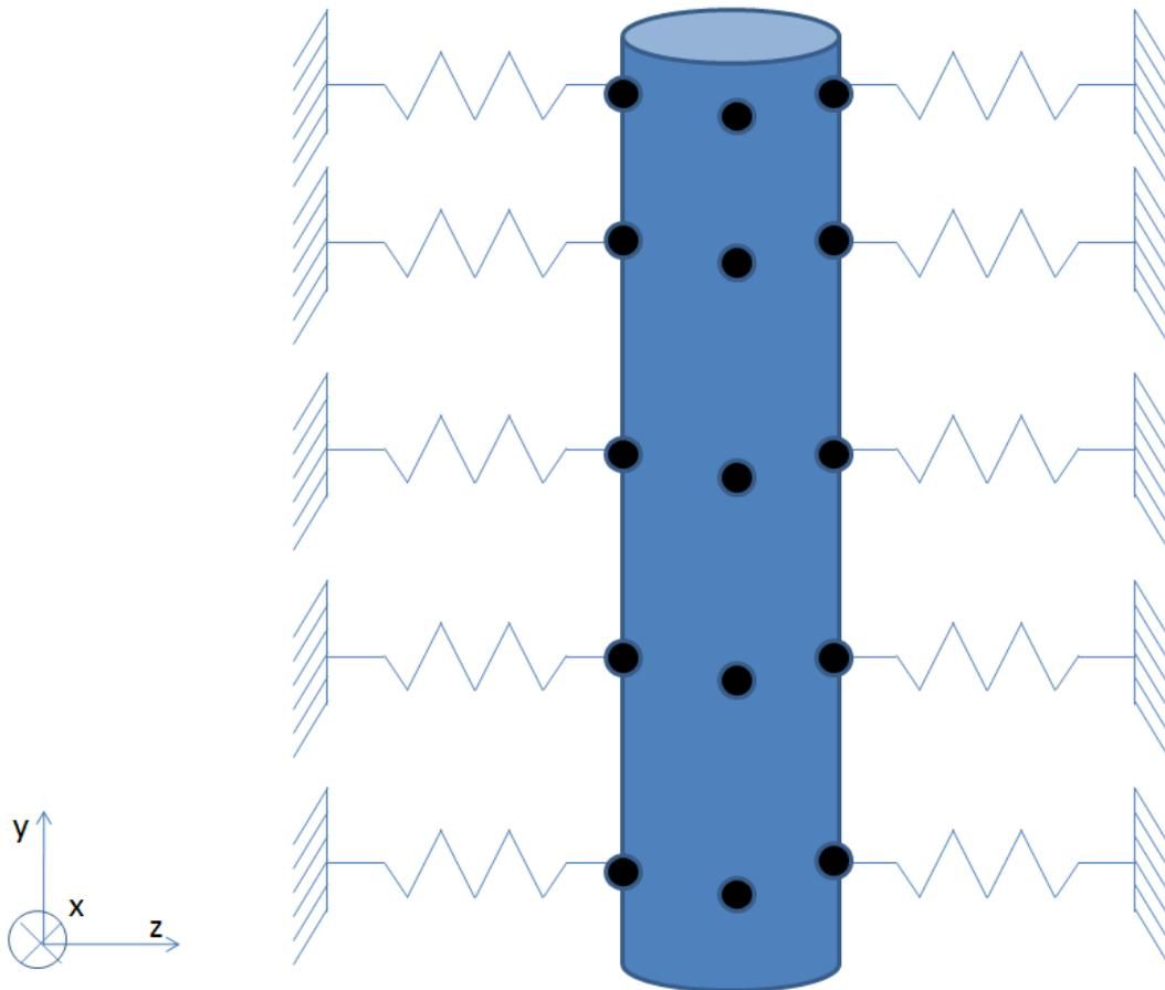
Les cotes des points d'appui sont : 0.3 m, 0.8 m, 1.29 m, 1.88 m et 2.09 m
