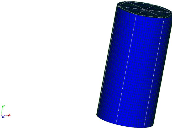
On considère un cylindre creux encastré à sa base et couvert sur sa face supérieure. Le cylindre fait  $2\text{ m}$  de long et  $1\text{ m}$  de diamètre.
