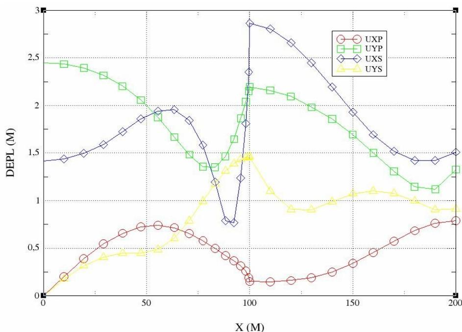
Figure 3.2.1 : réponses numériques maximales en X et Y à l'onde P et l'onde S
