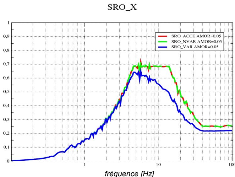
Remarque: Pour le cas test, le pas de temps des accélérogramme EUR a été multiplié par 2 (0.013672s au lieu de 0.006836s) afin d'accélérer les calculs. Aussi, les SRO calculés dans slds118b, vont de 0 à  $50Hz$  et non de 0 à  $100Hz$  comme sur la figure ci-dessus .
