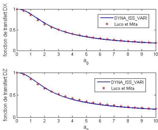
Pour le cas  $\alpha=0.0$ , on teste la réponse après projection sur coordonnées physiques. La fondation étant rigide et sans masse, tous les nœuds subissent le même déplacement qui est égale à 1.0 en direction  $x$  pour une excitation en direction  $x$ .
