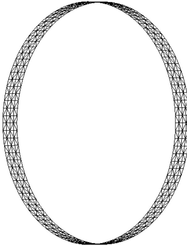
La géométrie discrétisée sur le rayon moyen  $R_m = 0.369 \text{ m}$  est représentée ci-dessus. Les éléments DKT et DST sont des facettes planes à trois nœuds de type TRIA3 disposées en étoiles. Le nombre de nœuds sur la circonférence est 100 et sur la longueur 5.
