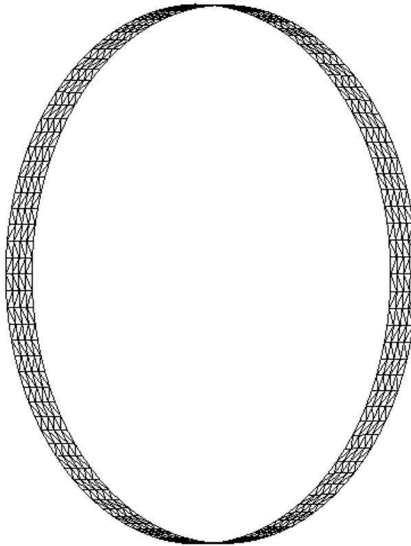
La géométrie discrétisée sur le rayon moyen  $R_m = 0.369 \text{ m}$  est représentée ci-dessus. Les éléments DKT et DST sont des facettes planes à trois nœuds de type TRIA3 disposées en épis. Le nombre de nœuds sur la circonférence est 100 et sur la longueur 5.
