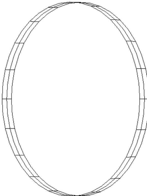
La géométrie discrétisée sur le rayon moyen  $R_m = 0.369 \text{ m}$  est représentée ci-dessus. Les éléments COQUE\_3D sont des mailles à 9 nœuds de type QUAD9 permettant de prendre en compte le rayon de courbure de l'anneau. Les nœuds milieux sont bien sur la circonférence moyenne. Le nombre de nœuds sur la circonférence est 40 et sur la longueur 5.
