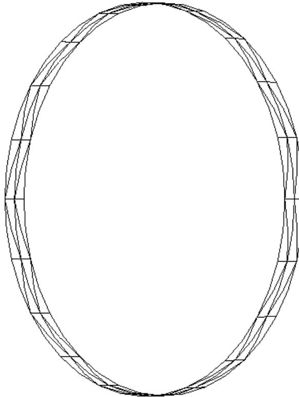
La géométrie discrétisée sur le rayon moyen  $R_m = 0.369\text{ m}$  est représentée ci-dessus. Les éléments COQUE\_3D sont des mailles à 7 nœuds de type TRIA7 permettant de prendre en compte le rayon de courbure de l'anneau. Les nœuds milieux sont bien sur la circonférence moyenne. Le nombre de nœuds sur la circonférence est 40 et sur la longueur 5.
