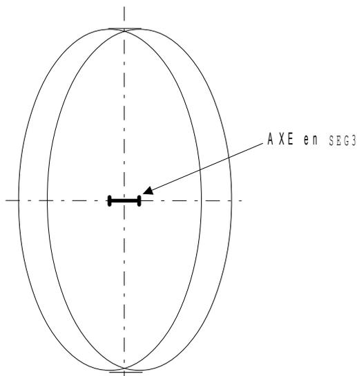
La géométrie discrétisée sur l'axe de l'anneau est représentée ci-dessus. Les éléments TUYAU et TUYAU\_6M sont des mailles à 3 nœuds de type SEG3 représentant l'axe de l'anneau. Le nombre de nœuds sur l'axe est 5.
