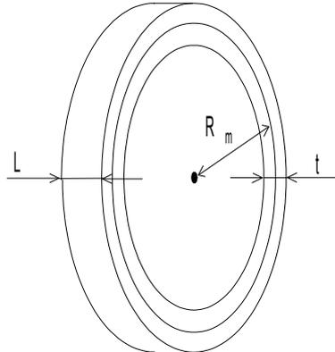
Il s'agit d'un anneau cylindrique, de rayon moyen  $R_m = 0.369 \text{ m}$ , d'épaisseur  $t = 0.048 \text{ m}$  et de longueur  $L = 0.05 \text{ m}$ .
