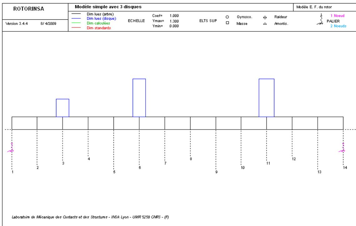
Figure 1-b : Caractéristique du modèle éléments finis sous ROTORINSA.
