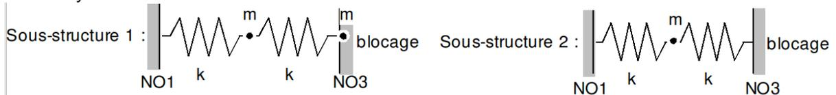
En situation, les deux sous-structures sont reliées au niveau de la 2ème masse. L'interface dynamique de la 1ère sous-structure est constituée d'une masse  $m$  au niveau du nœud  $NO3$  du maillage et coïncide avec l'interface dynamique de la 2ème sous-structure qui ne comporte aucune masse et est simplement bloquée au niveau du nœud  $NO1$ .
