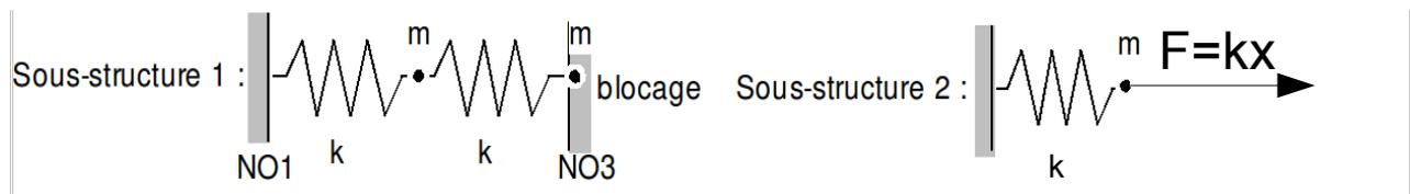
La réponse transitoire du système est calculée en utilisant des interfaces de type 'Craig-Bampton' (interfaces bloquées). On applique la méthode d'intégration par différences centrées. Le calcul de la réponse directe (sans sous-structuration) n'est pas repris dans cette modélisation.
