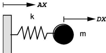
L'excitation est un mouvement sismique de type accélération imposée  $AX$  appliqué au support dans le sens  $DX$ .
