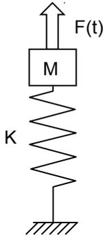
Le système à 1 degré de liberté est du type masse  $M$  à l'extrémité d'un ressort de raideur  $K$  orienté suivant la direction verticale  $z$ .
