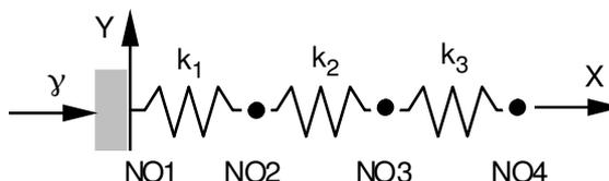
Le nœud *NO1* est encastré et soumis à une accélération imposée  $\gamma(t)$ . On calcule le déplacement relatif du nœud *NO4*.
