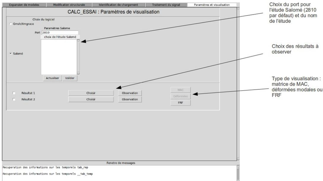
Figure 8-1: CALC\_ESSAI, onglet « Paramètres et visualisation »
