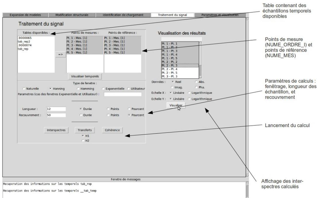
Figure 7-1: Onglet « Traitement du signal » de l'IHM CALC\_ESSAI
