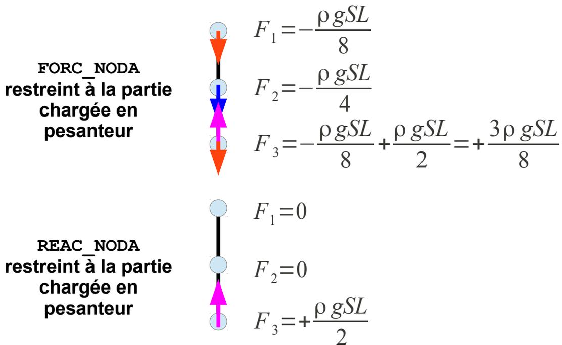
Figure 2.9.4-2: isolement d'une partie de la structure
