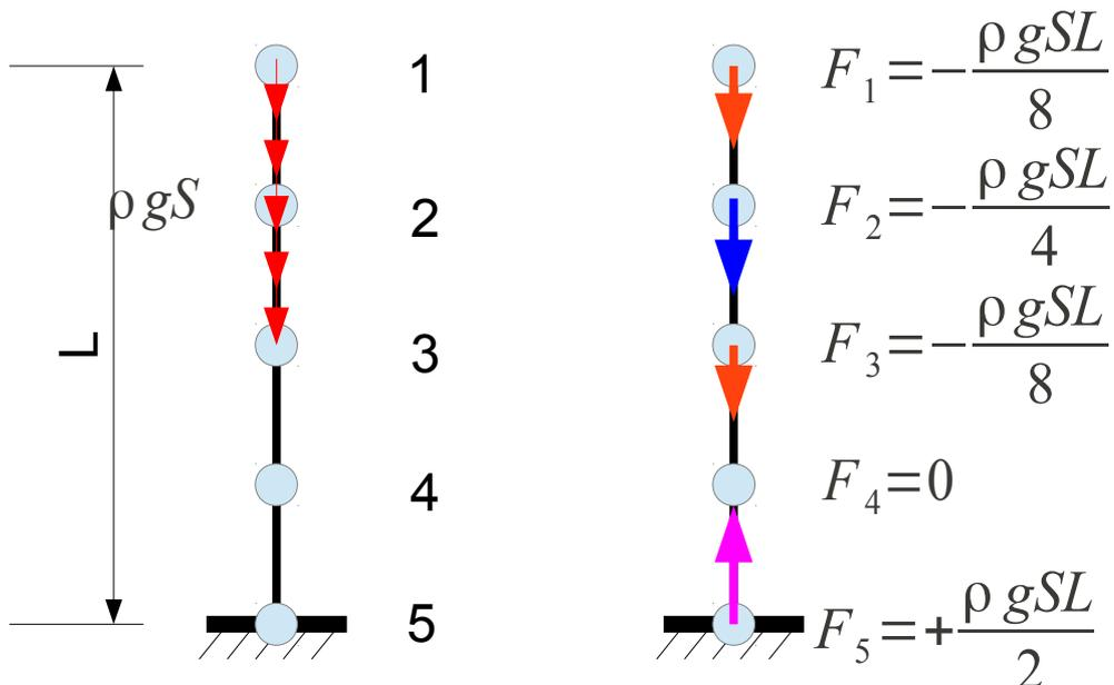
Figure 2.9.4-1: structure sous chargement réparti (gauche), FORC\_NODA (droite)
