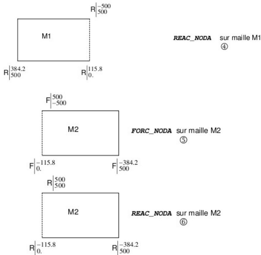
Sur cet exemple, les réactions aux nœuds (2) sont bien égales aux forces nodales (1) moins le chargement. Elles représentent les réactions aux appuis de la structure.
