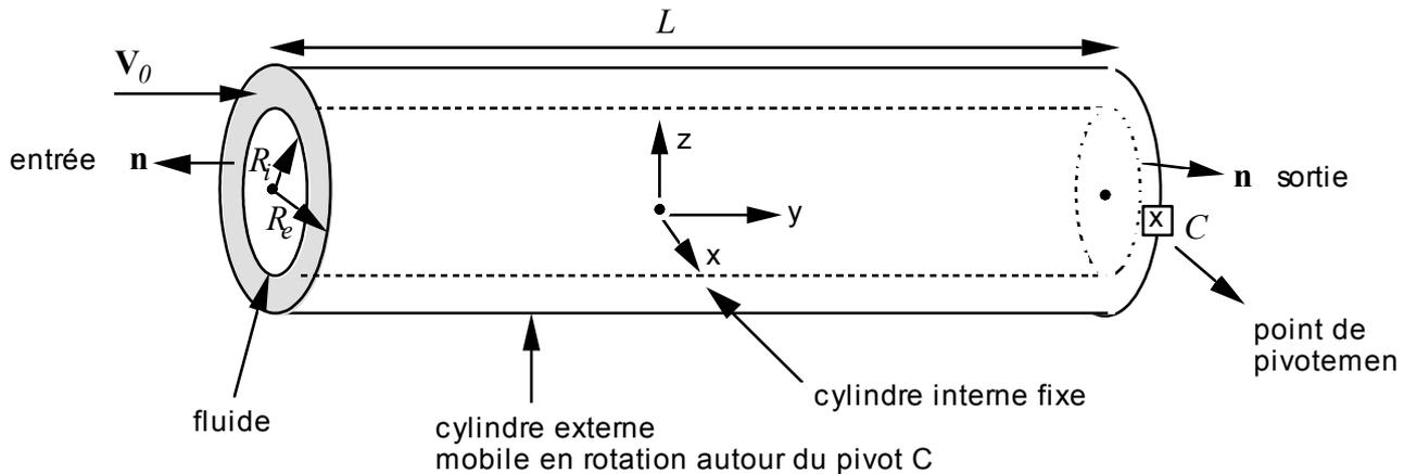
1) Après avoir modélisé la structure cylindrique et calculé ses modes en air, la commande MACRO\_MATR\_AJOU permet de calculer la masse, la rigidité et l'amortissement ajoutés par le fluide en écoulement sur cette structure :
