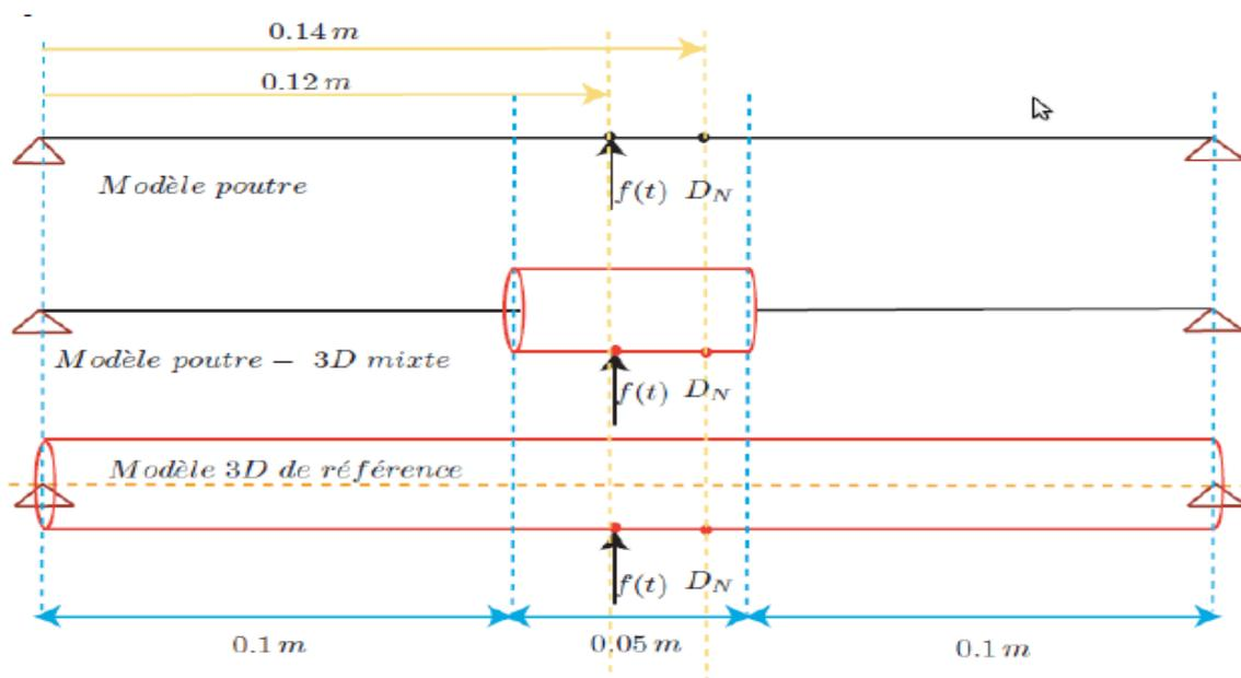
La simulation démarre par un modèle de poutre. Le calcul dynamique sur le mono-modèle de poutre a lieu de l'instant initial  $t_0$  jusqu'à l'instant de bascule au modèle 3D (ici,  $t_0=0s$ ,  $t_b=2.4s$ ).
