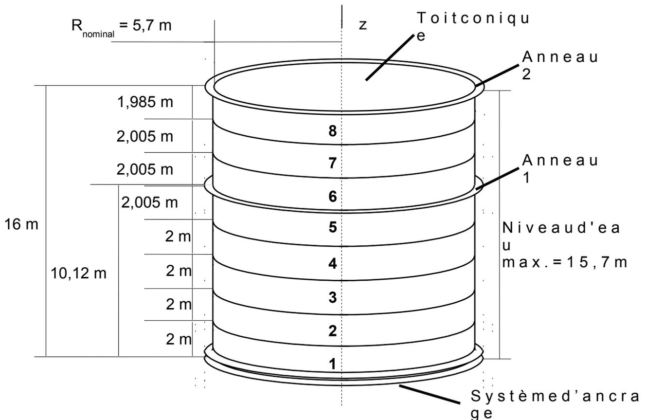
Figure 2.1-a : Représentation schématique d'une bache réelle
