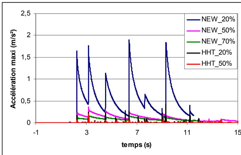
Sur la figure suivante, on peut juger de l'influence d'un paramètre de la discrétisation : le pas de temps, en terme de maîtrise de l'accélération maximale. La valeur de  $10^{-3}$  s pour le pas de temps n'est pas bien choisie et il est alors préférable de diviser le pas de temps par deux. Pour analyser ce comportement, il est indispensable de mener une étude paramétrique sur le pas de temps.
