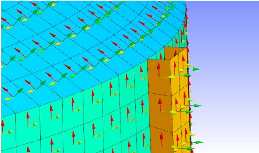
Figure 6.3.1-1: exemple de visualisation de l'orientation du repère local
