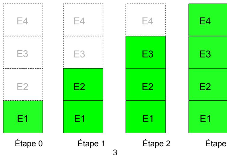
Dans cet exemple on souhaite simuler l'ajout progressif d'éléments dans l'étude comme par exemple simuler la construction d'un barrage en ajoutant successivement des couches d'éléments.
