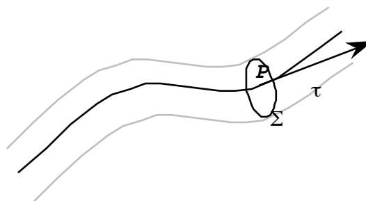
La force  $F$  se décompose en un effort normal  $N$  et des efforts tranchants  $T$  dans le plan de la section tandis que le moment  $M$  s'exerçant au point  $P$  se décompose en un moment de torsion et des moments fléchissants au point  $P$ .
