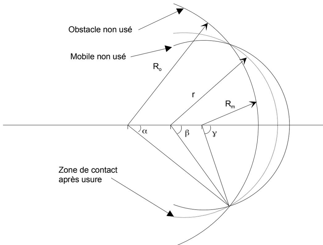
Un solveur numérique intégré au *Code\_Aster*<sup>®</sup> permet de résoudre ce système d'équations couplées à 4 inconnues,  $r$ ,  $\alpha$ ,  $\beta$ ,  $\gamma$ . Les profondeurs d'usure sont alors données par les relations suivantes :
