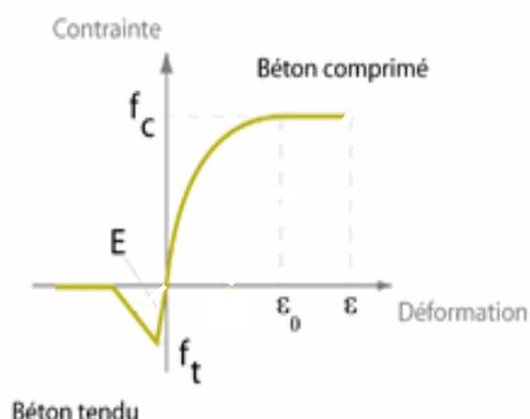
**Figure 1-a: courbe contrainte-déformation en 1D**
